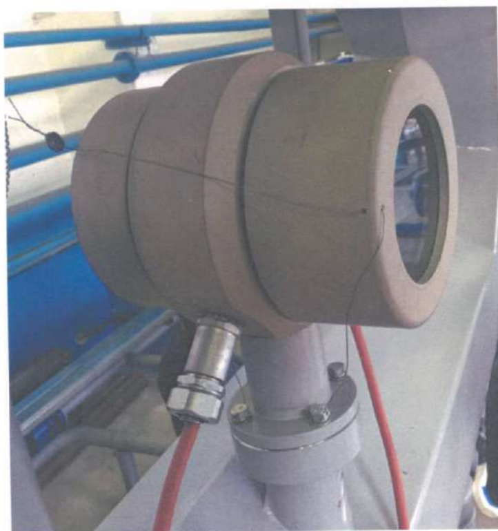
Рисунок 2 - Схема пломбировки счетчика от несанкционированного доступа.
